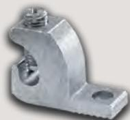
Le connecteur à cosse ouverte en cuivre E-Z-Ground de Thomas & Betts est idéal pour les applications de mise à la terre de piscines. Conception à cosse ouverte pour faciliter l'installation du conducteur de terre comme bretelle entre plusieurs conduits sans qu'il soit nécessaire de couper le conducteur. Marqué de l'inscription « DB » (direct burial) pour une pose en pleine terre. Calibres de conducteurs : à partir de 14 à 4 AWG ; gresseur de la cosse : 0,22 po (5,59 mm). Approbations UL, CSA.
