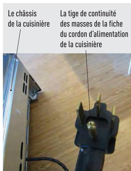
**Photo 2 :** Cordon d'alimentation et châssis arrière de la cuisinière
