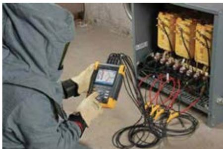
**Figures 4 :** Analyseur, pince ampère-métrique, multimètre et MDA-550 - Fluke
